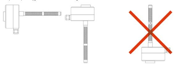
Kondensiertes Wasser darf nicht in das Gehäuseinnere gelangen.
