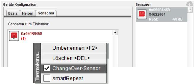
Zum Einlernen der Sensoren wie Raumtemperatursensor, Bewegungsmelder, Fensterkontakt werden die entsprechenden Sensorsymbole aus dem rechten Fenster in den Drop-Down Bereich des Reiters „Sensoren“ gezogen.
