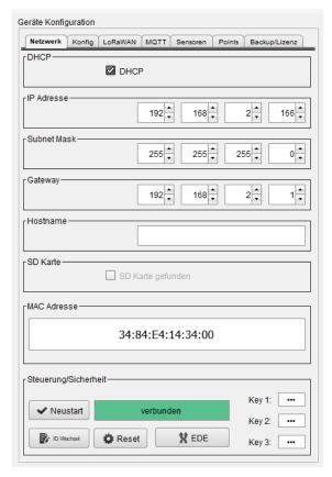
Mit DHCP fordert das verbindungssuchende Gateway die IP-Adresskonfiguration von einem DHCP-Server an.
