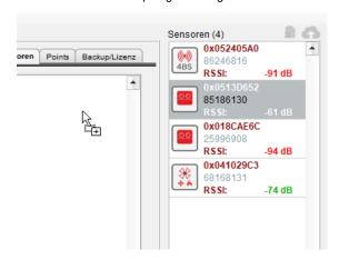
Der Bereich "Sensoren" zeigt die EnOcean Telegramme, die in BACnet-Datenpunkte umgewandelt werden können. Um Datenpunkte zu erzeugen, muss das Gateway die ID und das EEP des Sensors kennen, da dieses definiert, wie welcher Datenpunkt erzeugt wird. Daher können nur EnOcean Sensoren, deren EEP anhand des Lerntelegramms erkannt oder denen ein EPP manuell zugewiesen wurde, zugeordnet werden.
