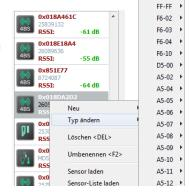
Eingelernte Sensoren können mit identischen Geräten mit identischem EEP ersetzt werden. (Rechtsklick -> ersetzen). Dies ist für einen Austausch / Ersatz von Geräten ohne Anpassung von BACnet Programmierung vorgesehen.
