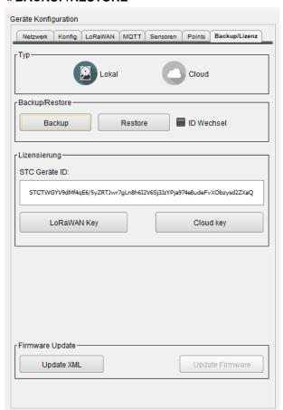
Airconfig kann die Konfiguration des STC-BACnet IP V4 auf Wunsch mit einer Cloud Funktion sichern. Nur mit einer Lokalen Sicherung ist ein späterer ID Wechsel möglich.
