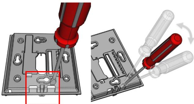
Auf der Oberseite der Grundplatte befinden sich Markierungen als maßhaltige Position für eine Bohrung max. Ø 6 mm
