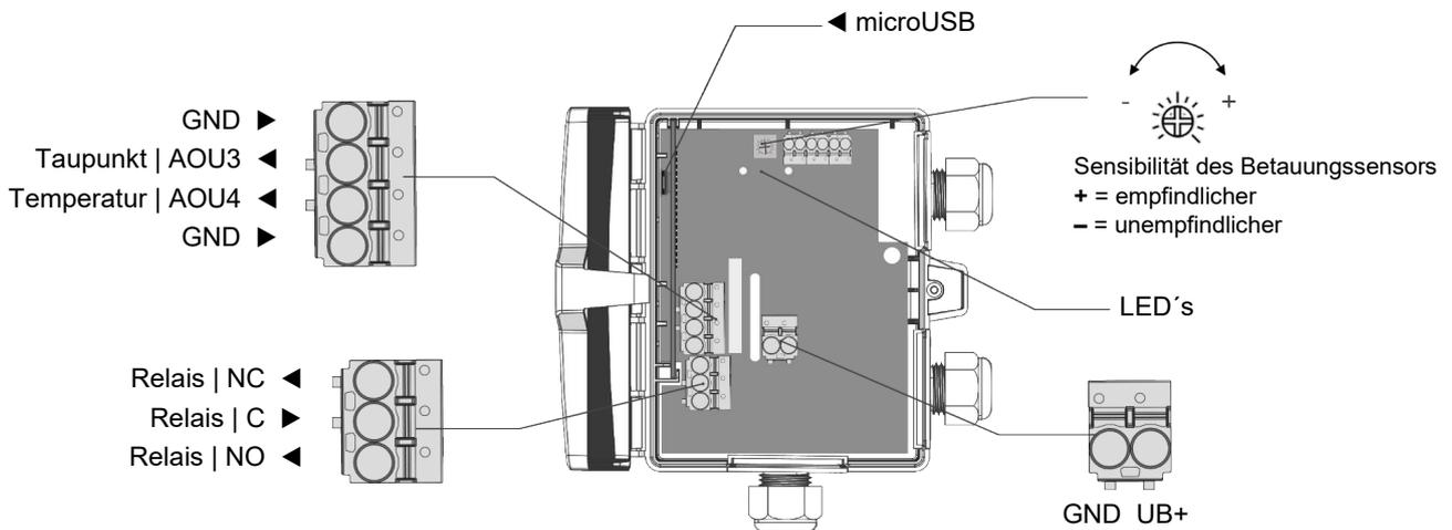
Das Relais ist im Betriebszustand angezogen: „Spannungsversorgung angeschlossen und nicht betaut“ (Relais NO und C verbunden). Bei Betauung oder bei Ausschalten der Betriebsspannung fällt es ab.
