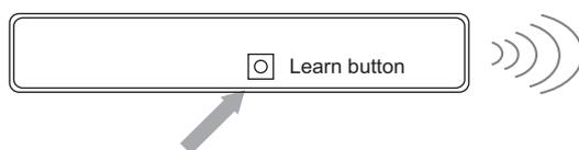
Einlern-Telegramm bei Tastendruck
