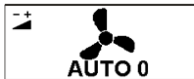
Abbildung 17 Anzeige Lüfterstufenverstellung
