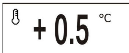
Abbildung 16 Anzeige Sollwertverstellung
