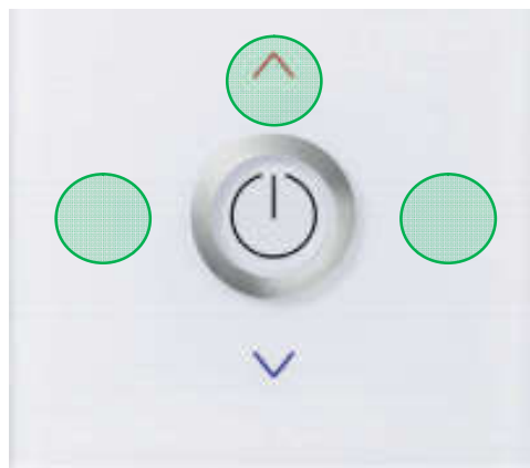
Abbildung 3 Tastenkombination HC-Variante zum Aufruf des Parametermenüs
