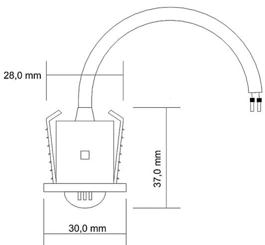
Anschlussgehäuse optional (Typ RDF18+ passiv)
