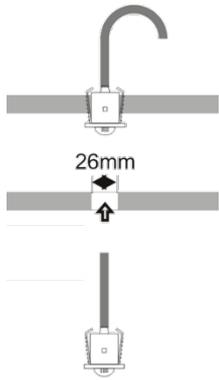
Die Geräte werden in einem betriebsfertigen Zustand ausgeliefert. Die Montage muss an repräsentativen Stellen für die Raumtemperatur erfolgen, damit das Messergebnis nicht verfälscht wird. Sonneneinstrahlung und Luftzug sind zu vermeiden. Des Weiteren sollte eine Montage in Türrähe (auftretende Zugluft) oder Fensternähe (kältere Außenwand) vermieden werden. Bohrung min.  $\varnothing$  26 mm, max.  $\varnothing$  28 mm.
