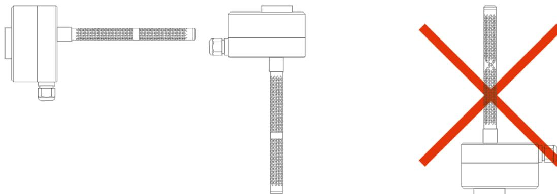
La condensation ne doit pas pénétrer dans le boîtier.
