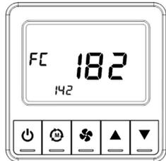
Die Geräteinformationen (Version und Typennummer) werden während des Gerätestarts im Display angezeigt.
