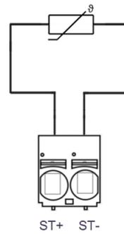
Abb.: (Anschlussbelegung passiver Sensor)
