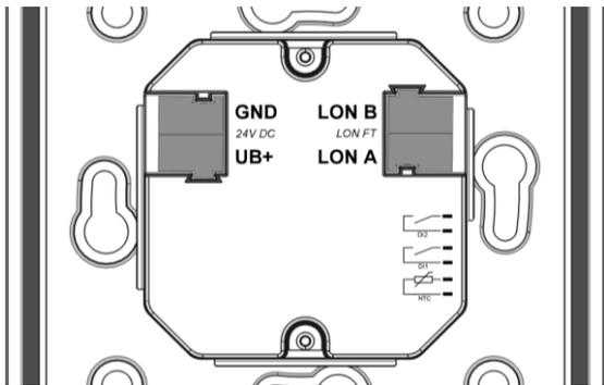
Seitlich im Gehäuseunterteil befindet sich eine Buchsenleiste zum Anschluss von bis zu 2 digitalen Eingängen und einem NTC10k. Der Anschluss wird über einen vorkonfektionierten Buchsenstecker (im Lieferumfang enthalten).
