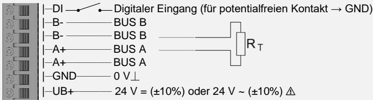
Bei Wechselspannung muss auf korrekte Polung geachtet werden!
