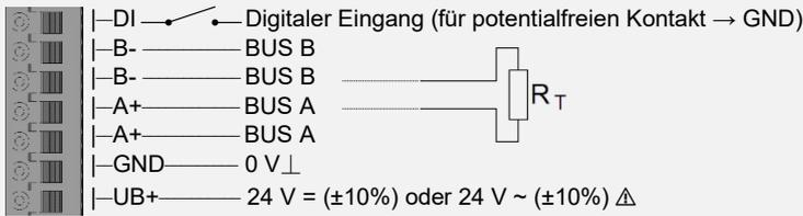
Bei Wechselfspannung muss auf korrekte Polung geachtet werden!
