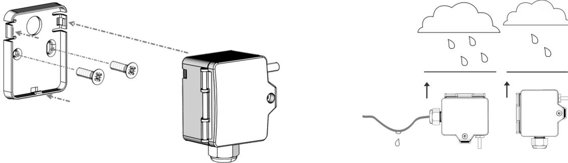
Unabhängig von der Himmelsrichtung sollte der Außenfühler an folgenden Orten nicht montiert werden:
