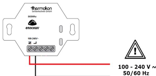
» **KONFIGURATION DES SRE-REPEATERS IN AIRCONFIG**
