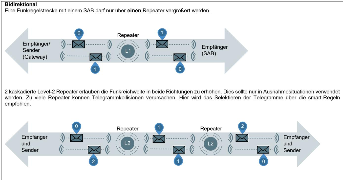
Bei der Funkreichweitenplanung sollte sichergestellt sein, dass der einwandfreie Empfang am Empfängerort gewährleistet ist. Eine Puffer der Signaldämpfung sollte für eine ggf. spätere Möblierung der Bauten berücksichtigt werden.
