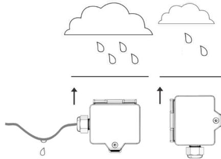
Unabhängig von der Himmelsrichtung sollte der Außenfühler an folgenden Orten nicht montiert werden:
