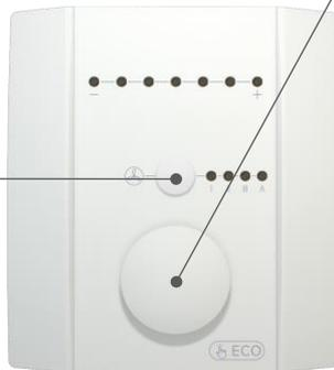
Durch Drücken wird die ECO-Funktion aktiviert/deaktiviert. Eine Verstellung des Sollwertes oder der Lüfterstufen im aktiven ECO-Modus ist nicht mehr möglich. Im ECO-Modus bleibt der eingestellte Sollwert-Offset im Modbus-Register erhalten und die Lüfterstufe schaltet in den Automatikmodus.
