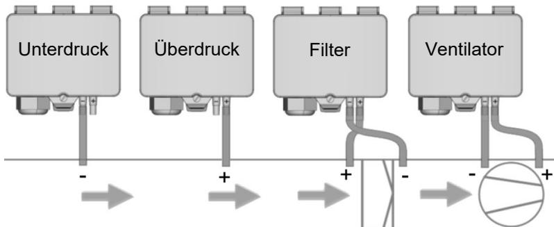
**1.** DPA+ Montagesockel an geeigneter Stelle montieren und DPA+ aufsetzen.
