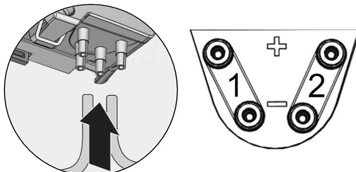
**4.** Druckschläuche an Kanal-Stutzen anschließen.
