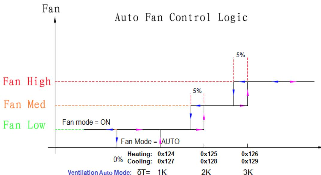
Der analoge 0..10 V Ausgang für den EC-Lüfter gibt im Automatikmodus den Spannungswert gemäß der Stellgröße des Reglers aus. Bei manueller Umstellung gelten folgende Spannungswerte für den EC-Ausgang:
