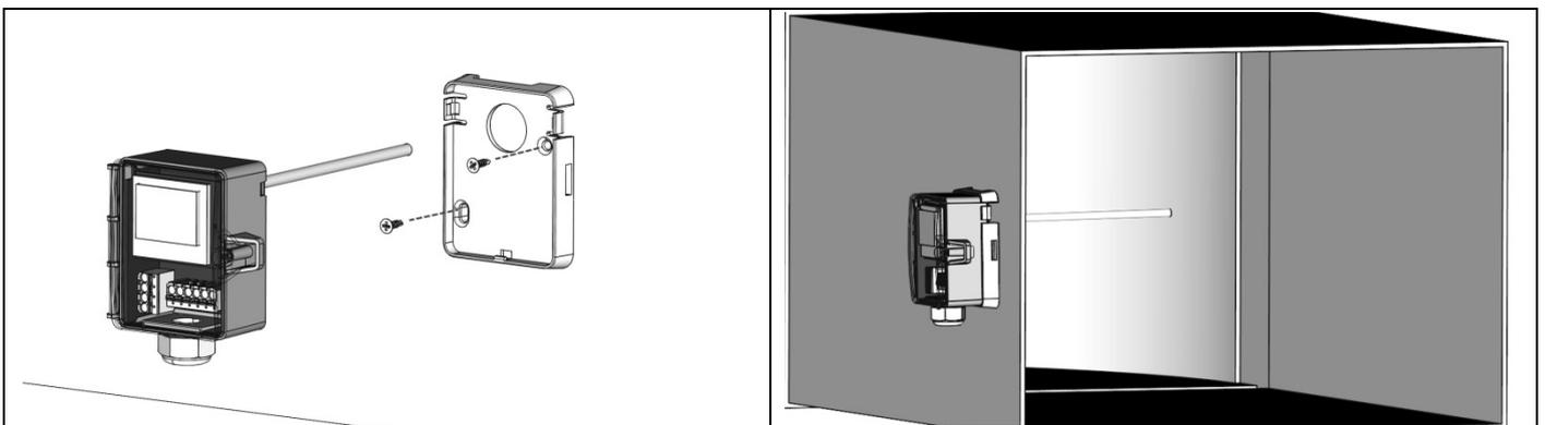
Einbau mit Tauchhülse oder Klemmverschraubung zur Verwendung in flüssigen Medien. Zur besseren Wärmeübertragung von der Tauchhülse auf den Sensor ist Wärmeleitpaste zu verwenden.
