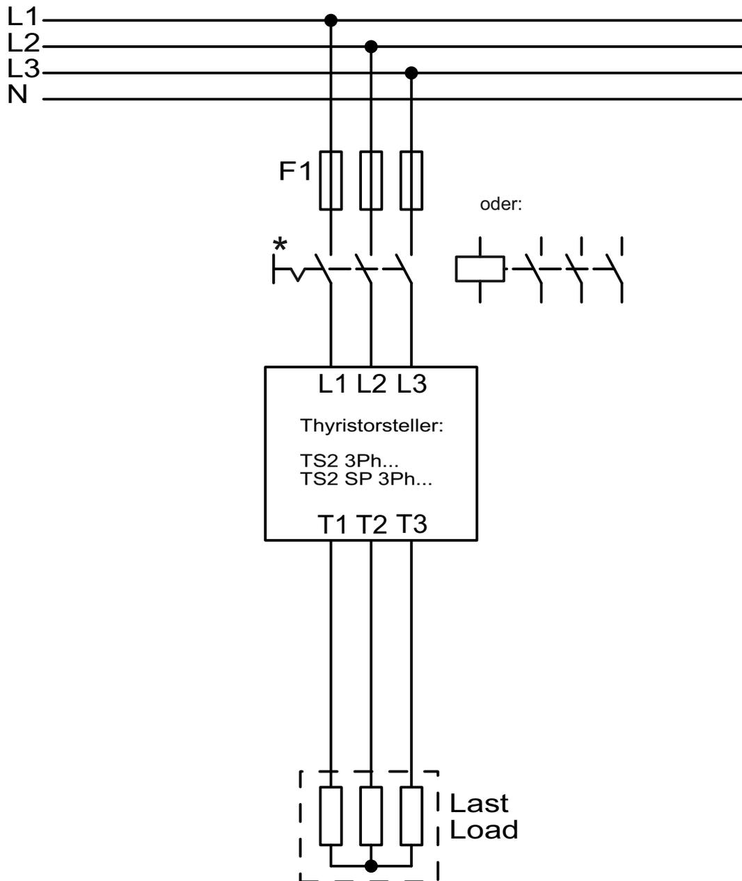
\* Zum Freischalten können Steckverbindungen, Schmelzsicherungen, LS-Schalter, Leistungsschalter, Lastschalter, Trennschalter und Fehlerstromschutzeinrichtungen (RCDs) dienen. Schütze können dagegen nur bedingt und in Ausnahmefällen zum Freischalten verwendet werden.
