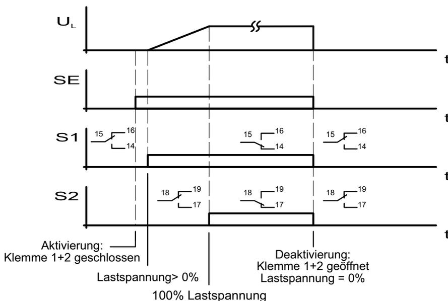
Die Schalterstellungen zeigen die Klemmkontakte 14 bis 19 der Steuerplatine.
