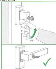
In der Verschlussstellung (0°-Position) lässt sich der Fenstergriff durch einen Schlüssel verriegeln und hat damit eine zusätzliche einbruchhemmende Sicherungsfunktion. Nur durch Entriegelung (Drehen des Schlüssels) kann der Griff in die Kippstellung (90°-Position) gebracht werden.
