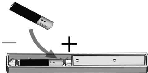
Batterie in Halterung einsetzen.
